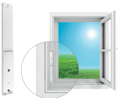
GHOST (oben) – Funk-Magnetkontakt, für den verdeckten Einbau in den Rahmen von Fenstern und Türen.
